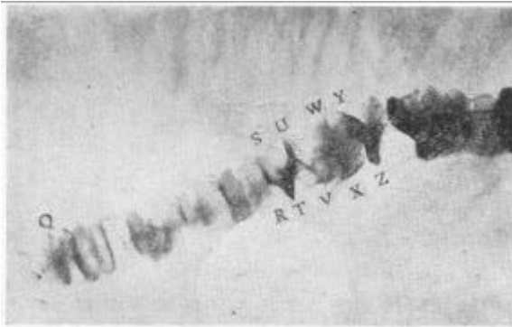
图 1 从聚乙烯的三氯乙烯溶液中得到的聚乙烯晶鬚 (6000 倍, Au 投影)
