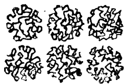
图 1.8 球状結構单元所組成的結晶示意图
