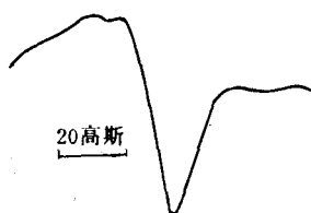
图 1 预辐照聚三氟氯乙烯薄膜 辐照剂量 3.5 \times 10^4 rad; 室温存放 2063 天; 自由基浓度 4.15 \times 10^{17} e/g
